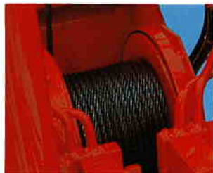
プランジャモータ採用の強カウインチ。
