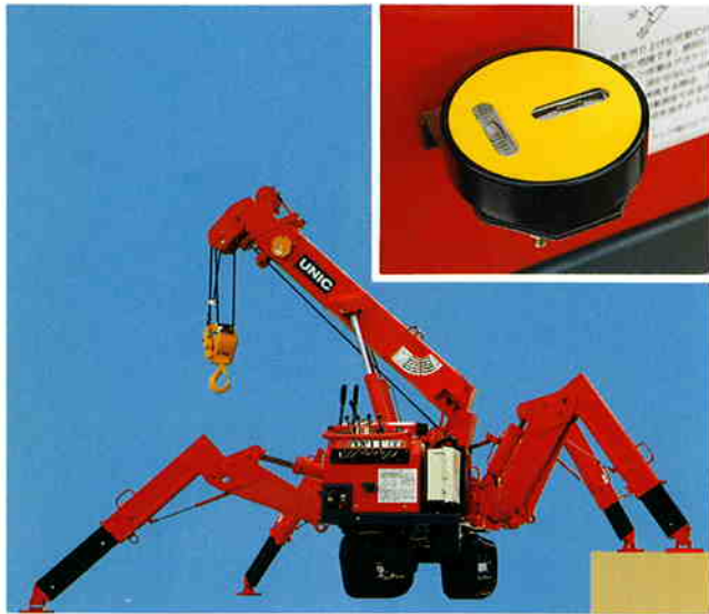
不整地でも確実に水平を保持する、ナックル型・自在アウトリガと大型水準器。
